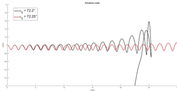
(a) Laufsimulation mit unterschiedlichen Beinwinkeln
