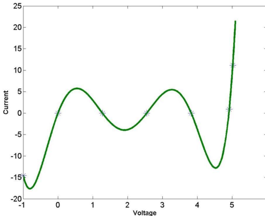
Abbildung 4: Spannungs-Strom-Kennlinie durch Polynom fünften Grades
