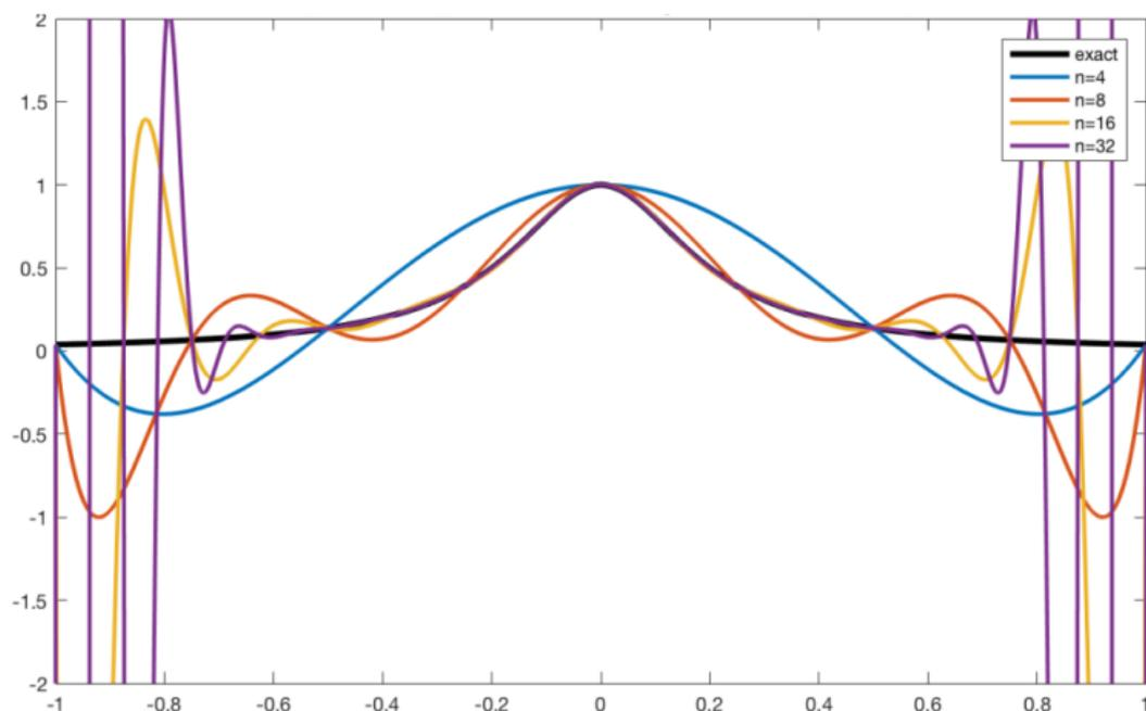
Abbildung 5: Graph der Runge-Funktion  $f(x) = \frac{1}{(1+25x^2)}$  mit äquidistanten Stützstellen für  $n = 4, 8, 16, 32$
