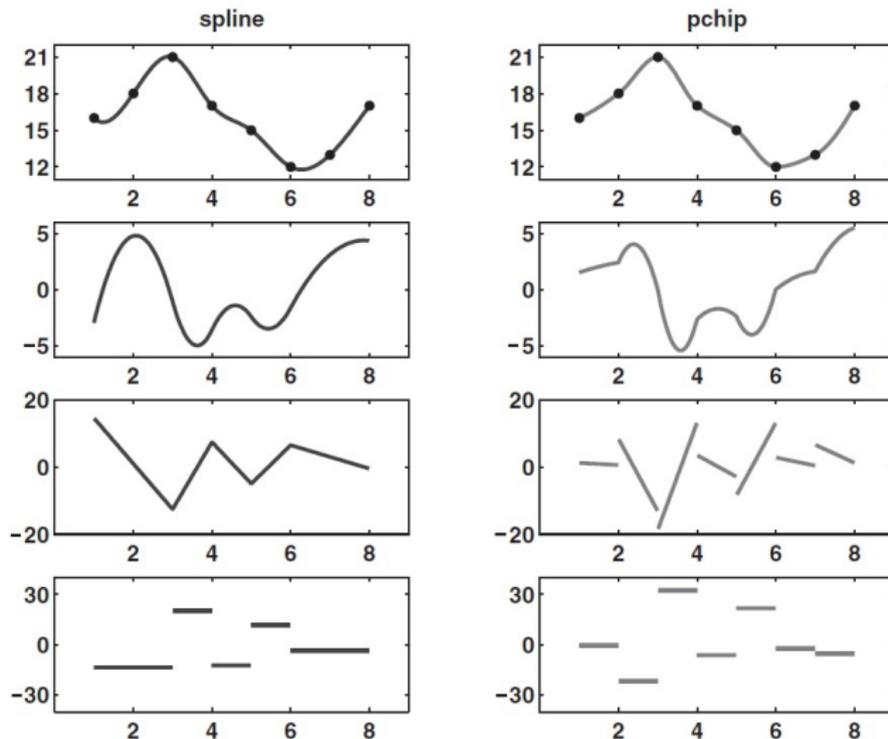
Abbildung 8: Vergleich Spline-Interpolation mit Hermite-Interpolation einschließlich der ersten 3 Ableitungen
