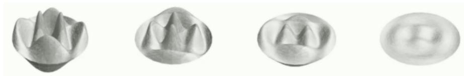
**Abbildung 4:** Eigenschwingung der Membran zu bestimmten Zeiten  $t$  [B1]
